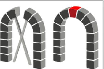
Em construções antigas as paredes eram construídas escoradas até que a **Pedra de Remate** estivesse na posição central e assim pudesse sustentar os dois lados.
